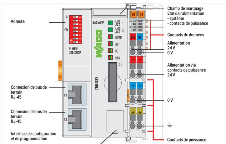
Le contrôleur BACnet/IP 750-832 permet de connecter les bornes WAGO-I/O-SYSTEM au protocole BACnet. Le 750-832 remplit les exigences du profil de dispositif BACnet B-BC selon la norme DIN EN ISO 16484-5. La communication avec d'autres dispositifs BACnet se fait par BACnet/IP.
