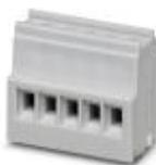
プリント基板用端子台, 定格電流: 8 A, 定格電圧: 160 V, ピッチ: 3.5 mm, 極数: 5, 接続方法: ネジ接続, 取付け方法: ハンダ接続, 電線/プリント基板の接続方向: 0 °, 側面にピン挿入口がある製品
