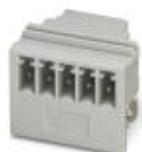
ソケット, 定格電流: 8 A, 定格電圧 ( III/2 ) : 160 V, 極数: 5, ピッチ: 3.5 mm, 取付け方法: ハンダ接続, 側面にピン挿入口がある製品
