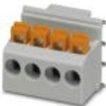
プリント基板用端子台, 定格電流: 22 A, 定格電圧: 250 V, ピッチ: 5 mm, 極数: 4, 接続方法: スプリング接続方式, 取付け方法: ハンダ接続, 電線/プリント基板の接続方向: 0°, 色: 淡い灰色, 側面にピン挿入口がある製品
