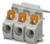
プリント基板用端子台, 定格電流: 24 A, 定格電圧: 630 V, 接続方法: スプリング接続方式, 取付け方法: ハンダ接続, 側面にピン挿入口がある製品
