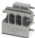
ソケット, 定格電流: 16 A, 定格電圧 ( III/2 ) : 320 V, 極数: 4, ピッチ: 5 mm, 色: 淡い灰色, 取付け方法: ハンダ接続
