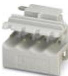
ソケット, 定格電流: 12 A, 定格電圧 ( III/2 ) : 320 V, 極数: 4, ピッチ: 5 mm, 取付け方法: ハンダ接続
