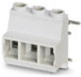
プリント基板用端子台, 定格電流: 24 A, 定格電圧: 630 V, ピッチ: 7.5 mm, 極数: 3, 接続方法: ネジ接続, 取付け方法: ハンダ接続, 側面にピン挿入口がある製品
