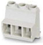
プリント基板用端子台, 定格電流: 24 A, 定格電圧: 630 V, ピッチ: 7.5 mm, 極数: 3, 接続方法: ネジ接続, 取付け方法: ハンダ接続, 側面にピン挿入口がある製品
