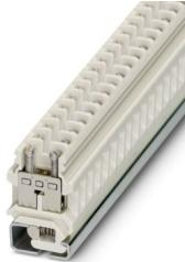
直通式接线端子，连接方式：螺钉连接，横截面积：0.5 mm<sup>2</sup> - 16 mm<sup>2</sup>，20 - 6 AWG，厚度：10.4 mm，颜色：白色，安装方式：NS 32，绝缘材料：陶瓷
