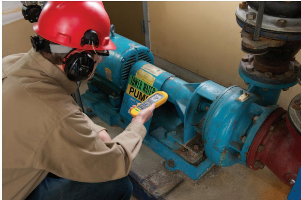
mit diesem Schwingungsmessgerät ohne spezielle Ausbildung zur Schwingungsanalyse die vielen Maschinen in der Anlage überwachen. Mit dem Fluke 805 werden Schwingungen schnell überprüft, damit der Benutzer erkennt, welche Maschinen in Ordnung sind und welche repariert werden müssen. Mit der Fluke Connect ShareLive-Videofunktion können Sie direkt und ohne Verlassen des Arbeitsorts Fragen klären oder Arbeiten autorisieren lassen.
