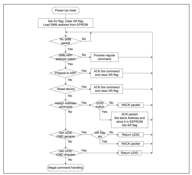
Figure 3.10. SMBus ARP Flow
