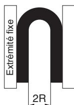
Pliez le tube en forme de U à une température de 20°C. Fixez une extrémité et fermez la boucle progressivement. Mesurez 2R lorsque le facteur de déformation du diamètre du tube atteint 5%.
