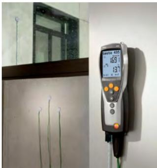
室内空気、外気温、壁表面温度を測定
