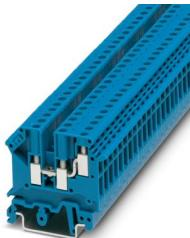
直通式接线端子，标称工作电压: 500 V，额定电流: 32 A，接线方式: 螺钉连接，第一层，额定接线容量: 4 mm<sup>2</sup>，横截面: 0.2 mm<sup>2</sup> - 4 mm<sup>2</sup>，安装方式: NS 35/7,5，NS 35/15，NS 32，颜色: 蓝色
