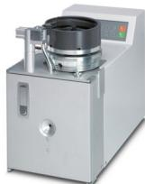
剥き工具、入力電圧100 ~ 240 V、断面積0.25 ~ 4.0 mm<sup>2</sup>の絶縁フェルール用、DIN 46228-4:1990-09に準拠、0.5 ~ 1.5 mm<sup>2</sup>の変換キットを含む（スリーブ長6 ~ 12 mm）
