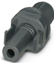
光伏连接器，产品范围: SUNCLIX，颜色: 黑色，位数: 1，额定电压: 1000 V DC，额定电流: 40 A，连接方法: 压接，触点类型: 孔式插头
