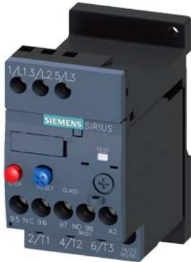
Überlastrelais 11...16 A thermisch für Motorschutz Baugröße S00, CLASS 10
