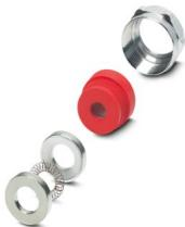
EMC Pg21半螺纹接头，适用尺寸2-4的金属外壳，包括橡胶密封圈、屏蔽弹簧、锥形环和紧固螺母，适用尺寸1外壳，电缆屏蔽长度范围[mm]5.5-9.5，电缆直径[mm]9-13
