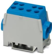
主线分支模块，标称工作电压: 400 V，额定电流: 125 A，连接量: 4，位数: 1，接线方式: 螺钉连接，第一层，额定接线容量: 35 mm<sup>2</sup>，横截面: 10 mm<sup>2</sup> - 35 mm<sup>2</sup>，螺钉连接，第2层，横截面: 1.5 mm<sup>2</sup> - 25 mm<sup>2</sup>，安装方式: NS 35/7,5，NS 35/15，颜色: 蓝色
