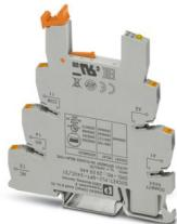
6,2 mm PLC-Grundklemme mit Push-in-Anschluss, ohne Relais- oder Solid-State-Relaisbestückung, zur Montage auf Tragschiene NS 35/7,5, 1 Wechsler, Eingangsspannung 24 V AC/DC
