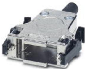
Capot D-SUB, indice de protection: IP20, matériau: Zinc coulé sous pression, sortie du câble: droite, taille de boîtier: 2, coloris: blanc métallique, Verrouillage par crochet encliquetable
