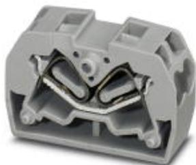
Doppel-Mini-Flanschklemmle, Anschlussart: Zugfederanschluss, Anzahl der Anschlüsse: 4, Querschnitt: 0,08 mm<sup>2</sup> - 4 mm<sup>2</sup>, AWG: 28 - 12, Breite: 10,4 mm, Höhe: 22 mm, Farbe: blau, Montageart: direktes Anschrauben
