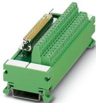
VARIOFACE-Modul, mit Schraubanschluss und D-Subminiatur-Stifteleiste, zur Montage auf NS 35/7,5, Polzahl 37
