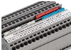
Le contact de pontage horizontal pour pontage continu, de 1 à 3, permet de ponter chaque deuxième borne dans un canal de pontage. Les potentiels plus et moins peuvent ainsi par ex. être distribués l'un à côté de l'autre.
