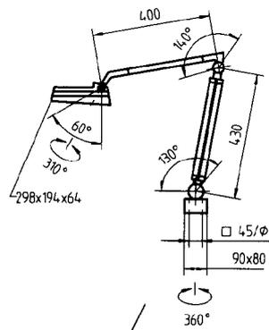
Maßzeichnung verkleinert. Alle wichtigen Daten über Abmessungen, Dreh- und Schwenkbereiche etc.
