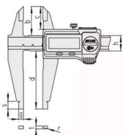
**b:** 40 mm**c:** 32.2 mm**d:** 90 mm**g:** 5 mm**s:** 10 mm**h:** 20 mm**t:** 3.8 mm**R:** 5 mm**Accessories**
