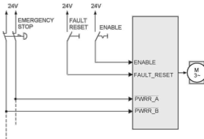
**Exemple d'application de la fonction de sécurité : Arrêt de catégorie 1**
