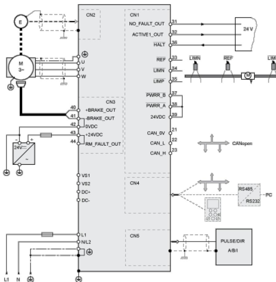
**Exemple d'application de la fonction de sécurité : Arrêt de catégorie 0**
