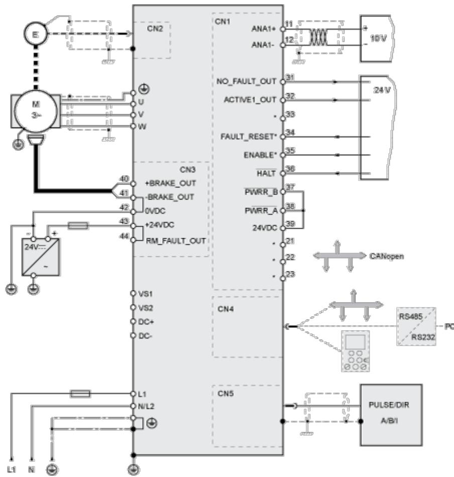
**SD328A - Exemple de connexion avec contrôle par bus de terrain**
