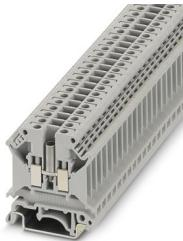
直通式接线端子，标称工作电压: 800 V，额定电流: 32 A，连接量: 2，接线方式: 螺钉连接，额定接线容量: 4 mm<sup>2</sup>，横截面: 0.2 mm<sup>2</sup> - 6 mm<sup>2</sup>，安装方式: NS 35/7,5，NS 35/15，NS 32，颜色: 灰色
