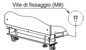
Fig. 3 Vite di fissaggio (8 pz.)
