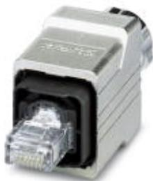
Connecteur RJ45, IP67, avec verrouillage Push-Pull, boîtier métallique, CAT5e, 4 pôles, avec raccordement autodénudant QUICKON, pour brins de 1 à 7 fils AWG 26 ... 22, pour câbles de diamètre 5,0 mm ... 8,0 mm
