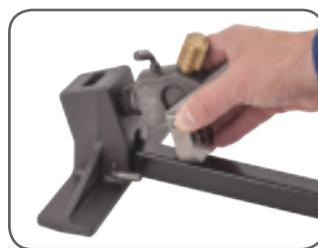
Der Manometeradapter wird auf das Gewinde des Manometers geschraubt, bis Dichtheit zwischen den Anschlussteilen hergestellt ist. (Fest anziehen!)
