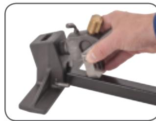
Visser à fond le raccord rectangulaire du manomètre dans le filetage du manomètre de façon à obtenir une bonne étanchéité. S'assurer que les surfaces planes du raccord sont alignés avec le manomètre.
