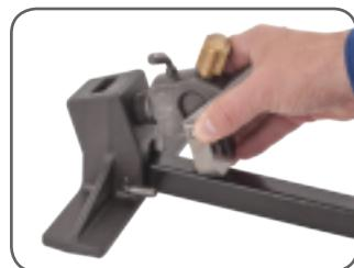
将方形的压力表连接头紧紧地拧到压力表的螺孔里，以保证良好的密封。
