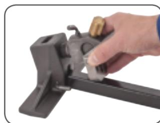
Avvitare strettamente il raccordo rettangolare nella filettatura del manometro, in modo da ottenere una tenuta soddisfacente. Verificare che le superfici piane del raccordo siano allineate con il manometro.
