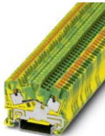
Bloc de jonction pour conducteur de protection, type de raccordement: Raccordement Push-in, nombre de connexions: 2, section : 0,14 mm<sup>2</sup> - 4 mm<sup>2</sup>, AWG: 26 - 12, largeur: 5,2 mm, coloris: vert/jaune, type de montage: NS 35/7,5, NS 35/15
