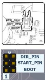
Abb. 5. START_PIN und DIR_PIN Jumper
