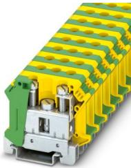
建筑安装用接地端子，螺钉连接，额定接线容量: 35 mm<sup>2</sup>，横截面: 0.75 mm<sup>2</sup> - 35 mm<sup>2</sup>，安装方式: NS 35/7,5 , NS 35/15 , 颜色: 黄绿相间
