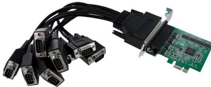
La Tarjeta Adaptadora PCI Express Nativo de 8 Puertos Serie RS232 con UART 16950, PEX8S952 permite convertir una ranura PCI Express en ocho conexiones serie RS232 (DB9) utilizando el cable multiconector incluido.
