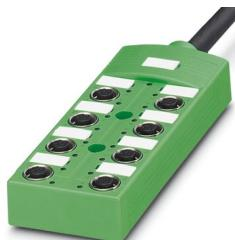
Verteilerbox, Anwendung: Standard, erweiterte Anforderungen, Anschlussart: M12-Buchse Metall, Anzahl der Steckplätze: 8, Polzahl: 4, Kodierung: A, Steckplatzbelegung: einfache, Statusanzeige: nein, Universal; Stammleitungsanschluss: Festanschluss 180°, PUR/PVC, Leitungslänge: 5 m, Schirmung: nein
