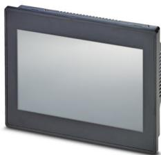
Touchpanel, 17.8 cm / 7"-TFT Display (analog-resistiv), 800 x 480 Pixel (WVGA), 16,7 Mio. Farben, Arm® Cortex®-A7, 528 MHz i.MX6 UL, 2x COM (RS-232/422/485), 1x USB 2.0, Typ A, 1x USB 2.0, Typ B, 1x Ethernet (10/100 MBit/s), RJ45, Windows® Embedded Compact 7, Visu+, ohne Bussystem.
