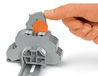
L'utilisation d'une plaque d'extrémité pour borne à fusible est nécessaire (par ex. 2002-1092, orange) en fin de montage ou s'il n'y a pas de borne à fusible adjacente.
