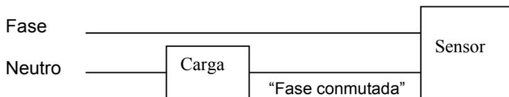
La carga debe conectarse entre el cable de neutro de la red eléctrica (en el caso de los modelos de tensión alterna ) o en cualquiera de los cables en los modelos de tensión continua (tienen protección de polaridad).
