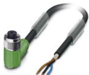
センサ/アクチュエータケーブル, 3-極, PUR ハロゲンフリー, 黒-灰RAL 7021, シールド対応, 片側フリー, 上ソケット アングル M12, Aコーディング, ケーブル長: 10 m
