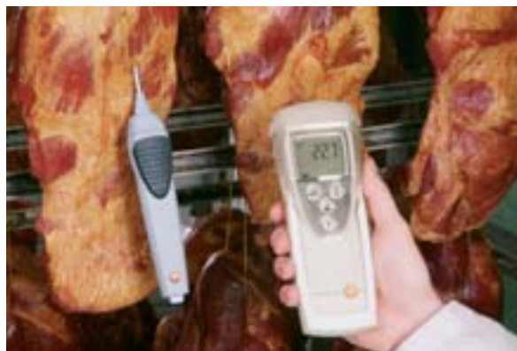
Misura della temperatura interna durante l'affumicatura degli alimenti, trasmissione radio dei dati senza cavi
