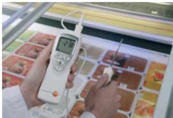
Misura della temperatura dell'aria nelle celle e nei banchi refrigerati
