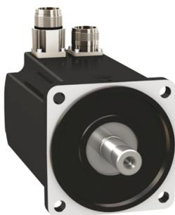
**Servomotor, Lexium BMH, 100mm, 6,0Nm, Passfeder IP54, Singelturn 16P/U, 2xM23 gerade**
