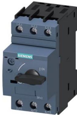
Leistungsschalter Baugröße S0 für den Motorschutz, CLASS 10 A-Auslöser 27...32 A N-Auslöser 400 A Schraubanschluss Standardschaltvermögen
