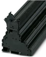
保险丝接线端子，保险丝类型: 玻璃 / 陶瓷 / ...，保险丝类型: G / 5 x 20，标称工作电压: 250 V，热持续电流  $I_{th}$ : 28 A，接线方式: 螺钉连接，额定接线容量: 4 mm<sup>2</sup>，接线容量: 0.14 mm<sup>2</sup>- 6 mm<sup>2</sup>，接线方式: 螺钉连接，额定接线容量: 4 mm<sup>2</sup>，接线容量: 0.14 mm<sup>2</sup>- 6 mm<sup>2</sup>，安装方式: NS 35/7,5，NS 35/15，颜色: 黑色
