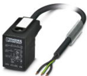
センサ/アクチュエータケーブル, 3-極, PUR ハロゲンフリー, 黒-灰RAL 7021, 片側フリー, 上 バルブプラグ BI ( 11 mm ), あり LED 1点, 接続は バリスタ, ケーブル長: 10 m
