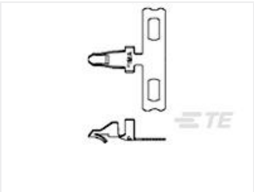
TE Part #350566-7 MINI AMP-IN 22-18 AWG POST TIN PLTD
