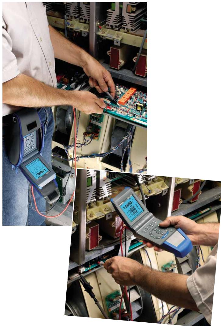
Afin d'améliorer l'efficacité et la sécurité lors des interventions, l'instrument ne comporte que 3 bornes de mesure.
