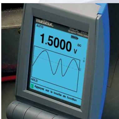
La commande "mesure préférée" ☺ rappelle directement une mesure spécifique d'usage régulier, préalablement définie par l'utilisateur. Ainsi, lors du mesurage d'une grandeur physique quelconque, cette touche permet de convertir l'échelle, de définir l'unité adéquate et d'obtenir ainsi la lecture directe de la grandeur d'origine.
