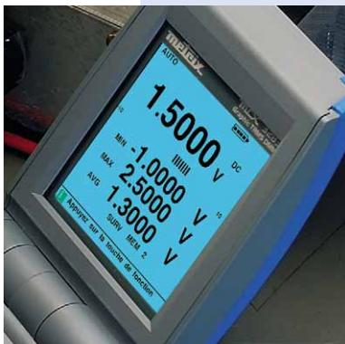
Les modes et fonctions sélectionnés, les grandeurs physiques ou électriques mesurées ainsi que les symboles d'alerte sont clairement reportés sur l'afficheur graphique haute résolution 160 x 160.
