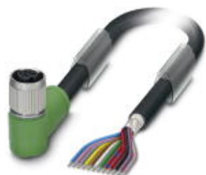
センサ/アクチュエータケーブル, 12-極, PUR/PVC, 黒RAL 9005, シールド対応, 片側フリー, 上 ソケット アン グル M12 SPEEDCON, Aコーディング, ケーブル長: 10 m
