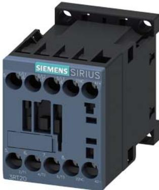
Leistungsschütz, AC-3e/AC-3, 7 A, 3 kW / 400 V, 3-polig, DC 24 V, 0,7-1,25\* Us, mit integrierter Supressordiode, Hilfskontakte: 1 Ö, Schraubanschluss, Baugröße: S00, geeignet für SPS-Ausgänge, nicht mit Hilfsschalter erweiterbar
