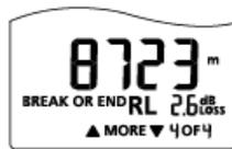
Die sich Rückfluss-Dämpfung der Faser (RL) ist 2,6 dB.
