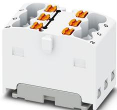
Bloc distributeur, pontage interne, tension nominale: 450 V, intensité nominale: 17,5 A, nombre de connexions: 6, type de raccordement: Raccordement Push-in, section : 0,14 mm<sup>2</sup> - 2,5 mm<sup>2</sup>, type de montage: encliquetage sur l'adaptateur de profilé, Montage direct avec bride, Volant, coloris: blanc
