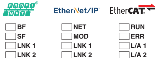
Bild 30 LED-Statusanzeigen für PROFINET, EtherNet/IP™, EtherCAT®
