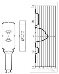
Distância de ligação protegida  $S_{Ao}$  9 mm. Observar áreas marginais na aproximação paralela: quando o atuador se move lateralmente à superfície do sensor, deve ser mantida uma distância mínima de 4 mm. Isso impede um disparo precoce causado pelas áreas de encosto laterais.
