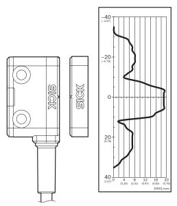
Distância de ligação protegida  $S_{Ao}$  14 mm. Observar áreas marginais na aproximação paralela: quando o atuador se move lateralmente à superfície do sensor, deve ser mantida uma distância mínima de 10 mm. Isso impede um disparo precoce causado pelas áreas de encosto laterais.
