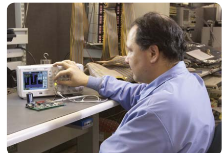
Figure 3. Le test de gabarit bon/mauvais standard est une des caractéristiques, entre autres, qui justifie l'utilisation de solutions série 1000 pour le test de fabrication et de maintenance.
