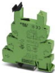
14 mm PLC- Grundklemme für hohe Einschaltströme mit Schraubanschluss, ohne Relais- oder Solid-State-Relaisbestückung, zur Montage auf Tragschiene NS 35/7,5, mit Lastrückleiteranschluss (BB), 1 Schließer, Eingangsspannung 24 V DC
