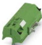
V8-Adapter für 8 x PLC-INTERFACE (14 mm); Steuerung: SPS-Systemverkabelung von Ausgangskarten; Anschluss 1: Steckanschluss (Aufrastbar auf 8x PLC-INTERFACE-Klemmen); Anschluss 2: 1x IDC/FLK-Stiftleiste (14-polig); Anzahl der Kanäle: 8; Ansteuerlogik: plusschaltend
