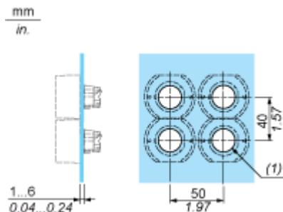
(1) Ø 22,5 mm recommandé (22,3  $^{+0,4}_0$ ) / Ø 0.89 po. recommandé (0.88  $^{+0,016}_0$ )
